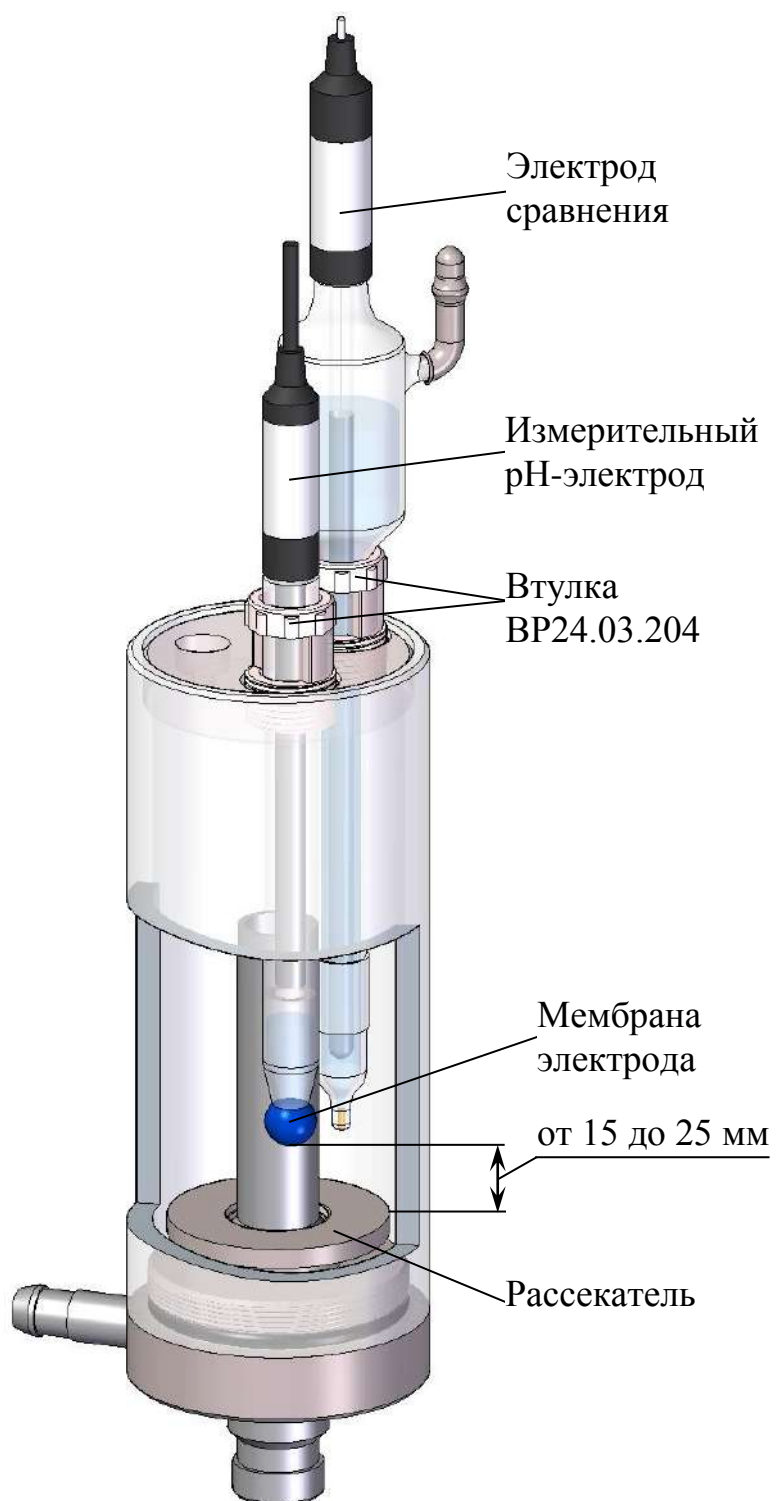
Рисунок 3.2 – Расположение раздельной пары рН-электродов в ячейке проточной BP31.04.400 (вид с местным разрезом)
